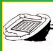
Los minicordones pueden utilizarse para evitar que los derrames caigan a las alcantarillas.
